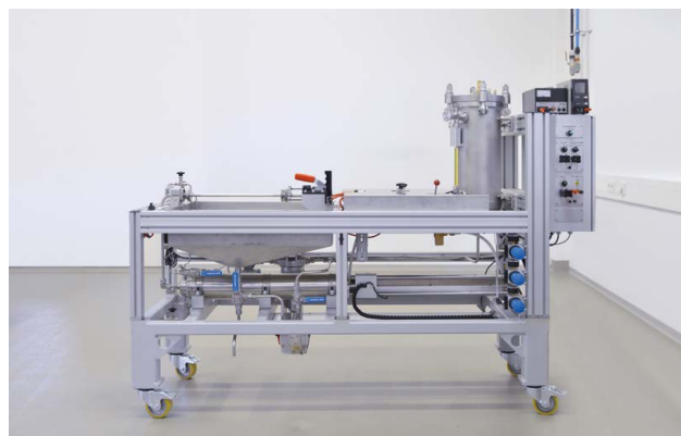
Flüssigkeitskalibrator für kleine Durchflussmengen 0,8 ml/min - 40 l/min
