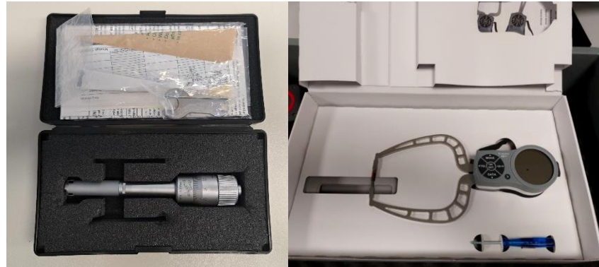
Abbildung 2: Kalibriergegenstände von links nach rechts: 1) 3-Linien-Innenmessschraube, 2) Außenschnelltaster 0 mm bis 30 mm
