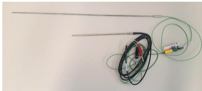
Abbildung 1: Beispielbild für Nichtedel-Thermoelement. Hier: Thermoelement Typ K mit Vergleichsstelle.
