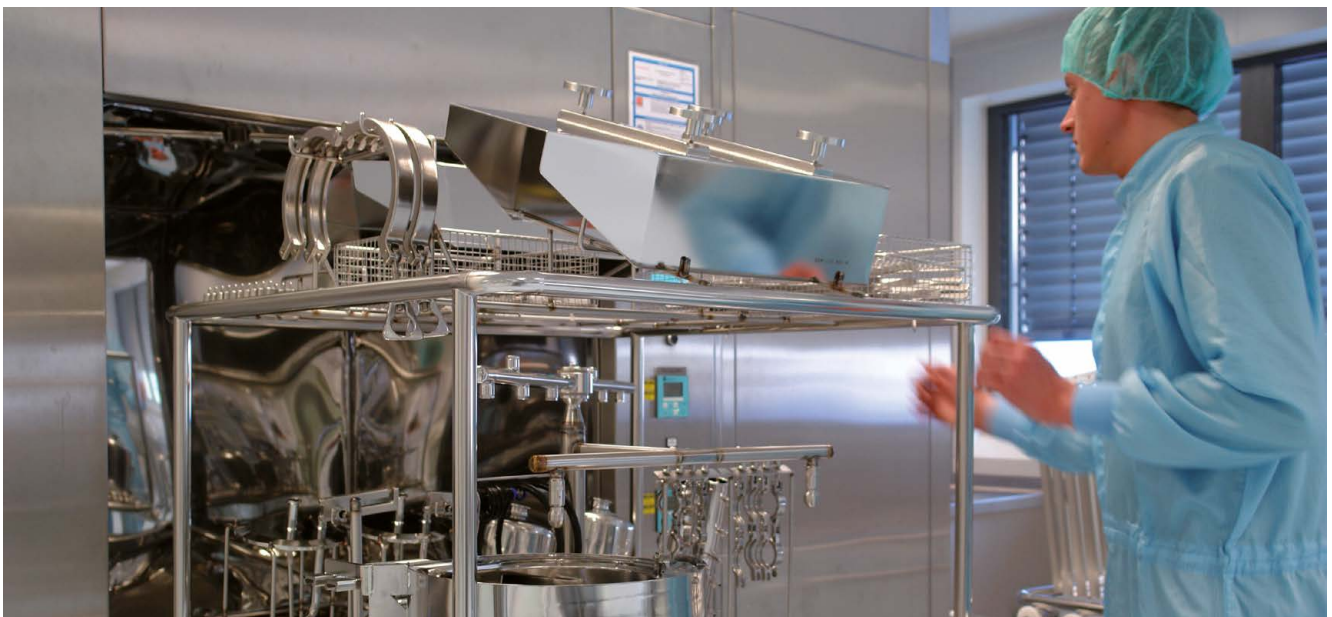
Beladung der Spülmaschine bei der Qualifizierung
