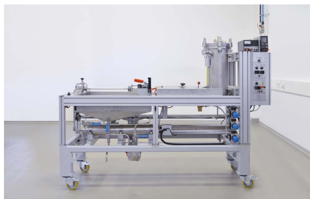
Flüssigkeitskalibrator für kleine Durchflussmengen 0,8 ml/min - 40 l/min
