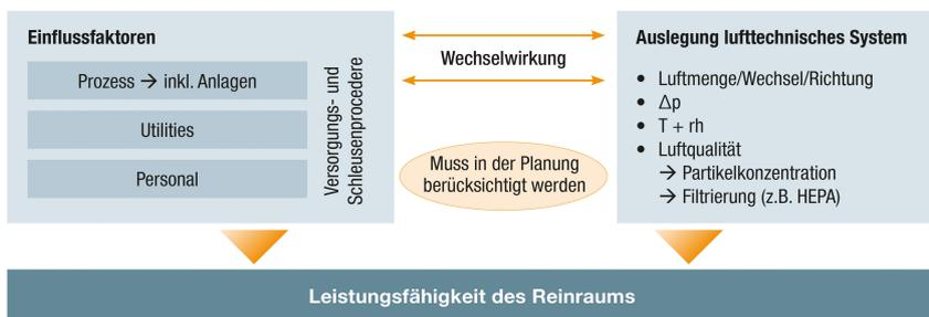
Abbildung 3: Darstellung der Abhängigkeit der Leistungsfähigkeit eines Reinraums.
